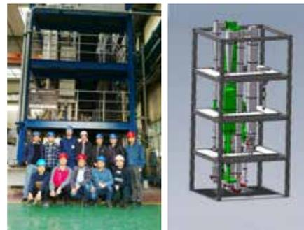
Maquette de 1,5 MWth de la boucle entière opérée pour différentes conditions de flux de solide et de gaz.
